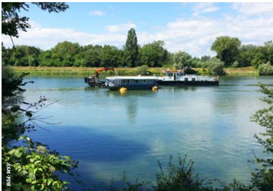
Das havarierte Hausboot wurde 2016 mit Luftsäcken angehoben und dann in tiefere Gewässer geschleppt
