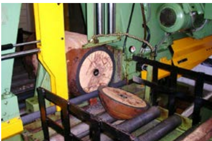
Wasserschneidesäge trennt Zünder aus dem Stahlmantel um die Bombe zu Entschärfen
